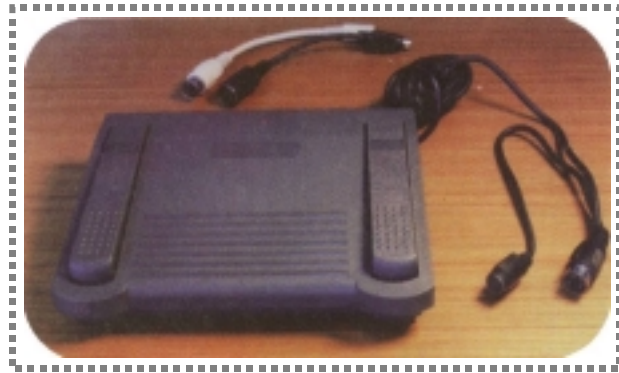
발입력장치 프로그램가능한 발스위치를 리용하여 손을 휴식시킨다. 발스위치를 리용한 3개의 단추를 가진 발건반 만능입력장치를 추가한다.
